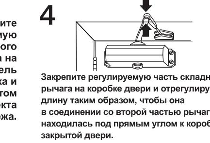
Закрепите регулируемую часть складного рычага на коробке двери и отрегулируйте длину таким образом, чтобы она в соединении со второй частью рычага находилась под прямым углом к коробке закрытой двери.
